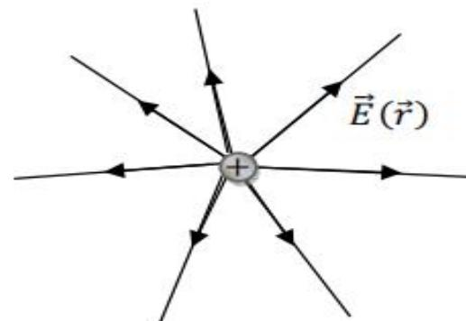
✓ وحدة الحقل الكهربائي في النظام الدولي SI هي  $N C^{-1}$  (سنرى فيما بعد أنه يمكن استعمال وحدة أخرى هي  $V m^{-1}$ ).
