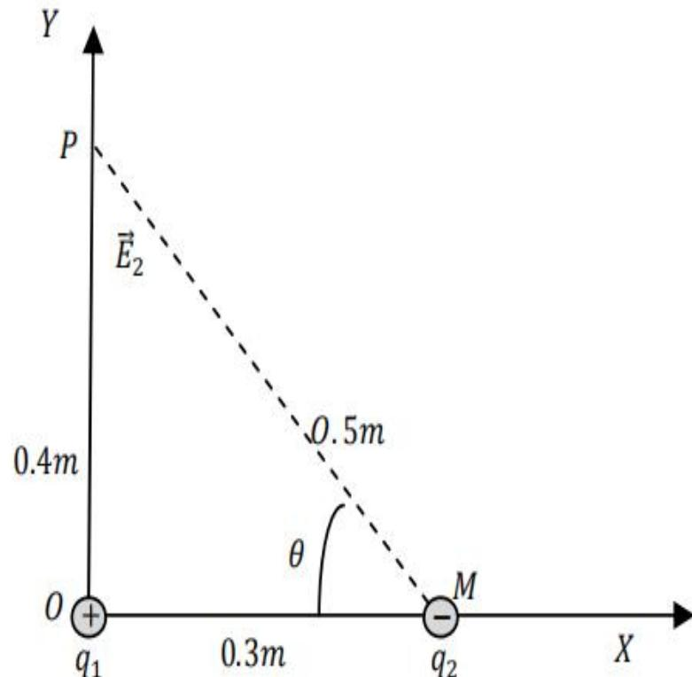
في المعلم  $OXY$ , وضعت الشحنة  $q_1 = 7\mu C$  عند النقطة  $(0,0)$ , و وضعت الشحنة  $q_2 = -5\mu C$  عند النقطة  $M$  ذات الإحداثيات  $(0.3,0)m$ , أنظر الشكل.
